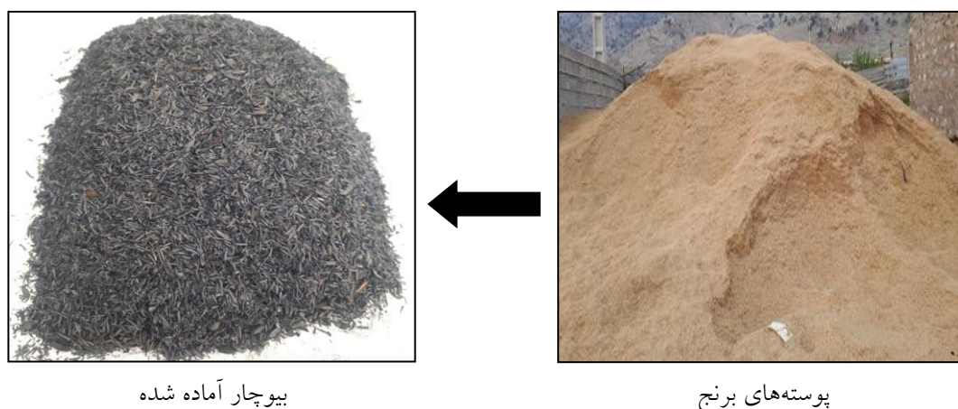
شکل ۱- تبدیل پوسته برنج به بیوچار در دمای ۴۵۰ درجه سلسیوس.
