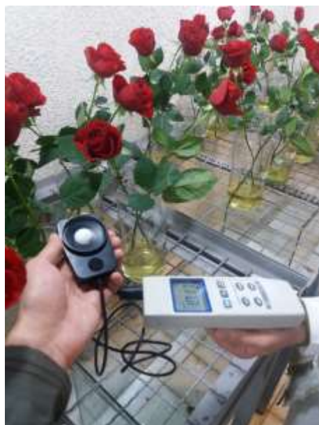
شکل ۱- تنظیم شدت نور با کاربرد دستگاه لوکس متر.
